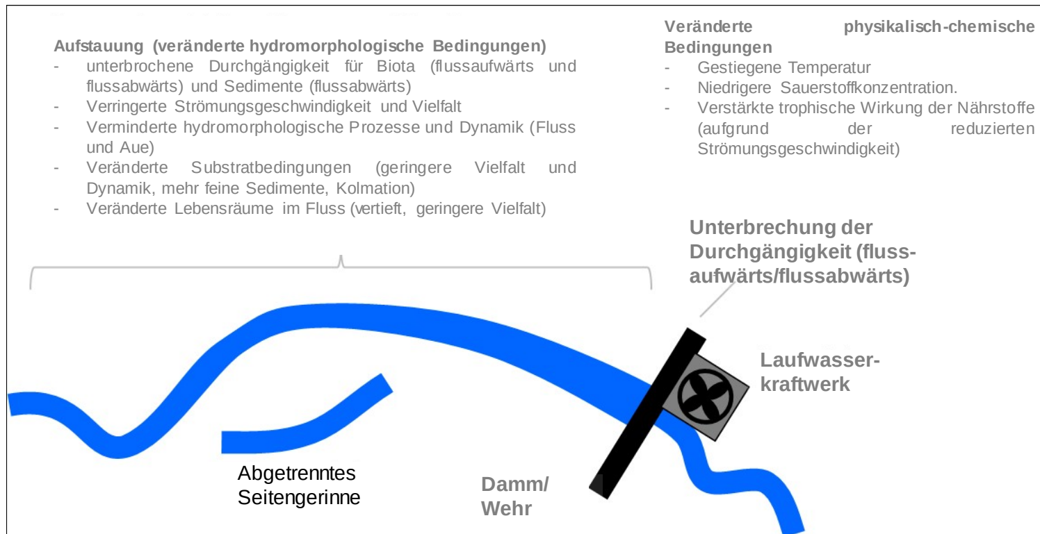
Abbildung 11: Aufstauung eines Flusses mit Angabe der Auswirkungen
