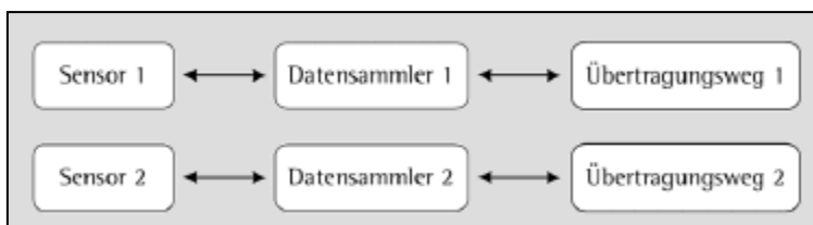
Abbildung 39: komplett redundante Messstelle
